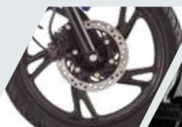
**SISTEMA DE FRENOS LIBRE DE ASBESTO**
